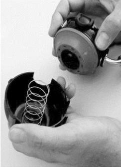
**Fig. 32 Montaje del Volante Manual**
