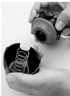
**Bild 32 Montage Handrad**
