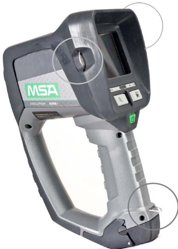
Fig. 3 Ubicación del cable de fijación
