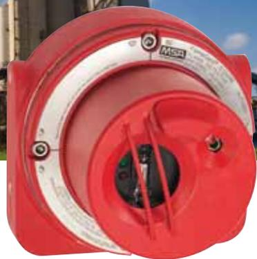
IR-H2 detecta chamas de hidrogênio. O Monitoramento Contínuo do Trajeto Óptico (COPM) verifica a integridade do trajeto óptico e o circuito eletrônico do detector a cada minuto.
