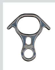
O Freio 8 é desenvolvido para trabalhos em altura, onde a corda é o meio de acesso, e o freio é utilizado como descensor. O dispositivo é fabricado em aço com capacidade de 30kN. Pode ser utilizado em cordas com diâmetro de Ø11mm a Ø16mm. O equipamento não é auto-blocante.
