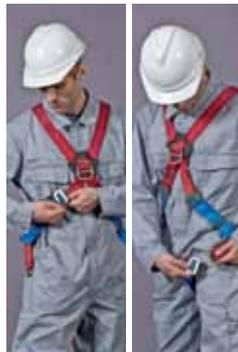
Feche as fivelas frontais através das fitas que saem da argola frontal com as fitas inferiores. Na sequência, feche as fivelas das pernas.
