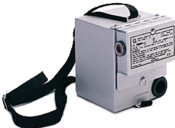
Рисунок 53: 3-литровая калибровочная камера для калибровки парами растворителей и летучих жидкостей.
