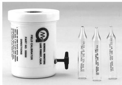
Figure 20 : ampoules avec bouteilles de broyage
