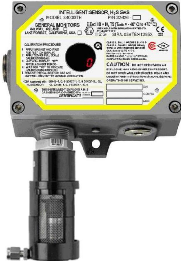
Figure 6 : détecteur intelligent modèle S4000TH avec RGC
