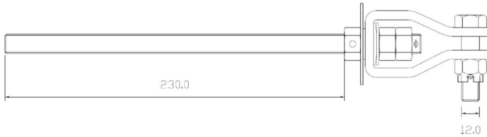
Anzeige für die Seilvorspannung (Rechtsgewinde), verlängert
