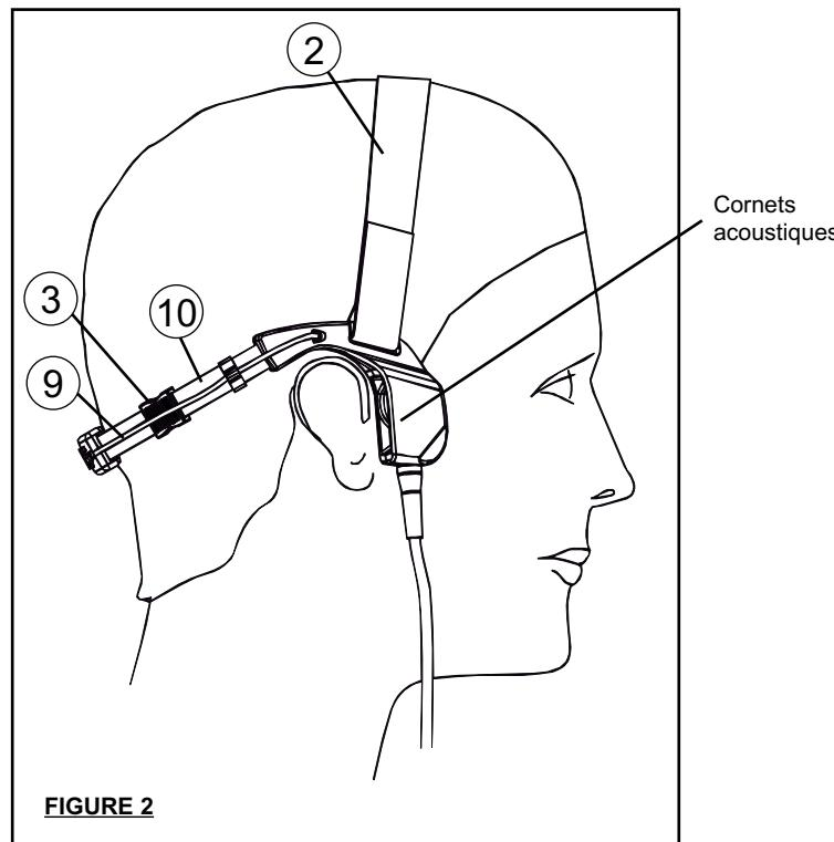
Placez l'équipement sur la tête comme indiqué sur la figure 2. L'arceau (10) est en contact avec la nuque et la sangle (2) passe par le sommet de la tête. Réglez les dimensions de l'arceau (2 demi-arceaux télescopiques) avec les deux boutons (3), de façon à faire plaquer les deux cornets acoustiques sur les tempes.
