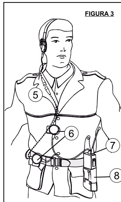
Conecte la clavija de conexión ⑦ al poste emisor/receptor ⑧ (poste apagado).
