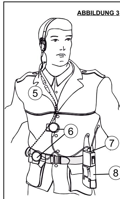
Den Anschlußstecker (7) an das Sende-Empfangs-Gerät anschliessen (8) (Funkgerät gelöscht).
