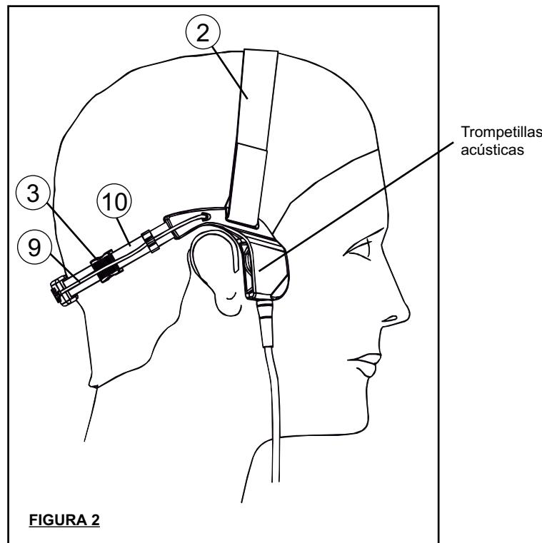
Colóquese el equipo en la cabeza tal como indica la figura 2. El aro ⑩ debe estar en contacto con la nuca y la banda ② debe pasar por la parte superior de la cabeza. Regule las dimensiones del aro (dos semiaros telescopicos) mediante los dos botones ③ de manera que los dos auriculares queden sobre las sienes.
