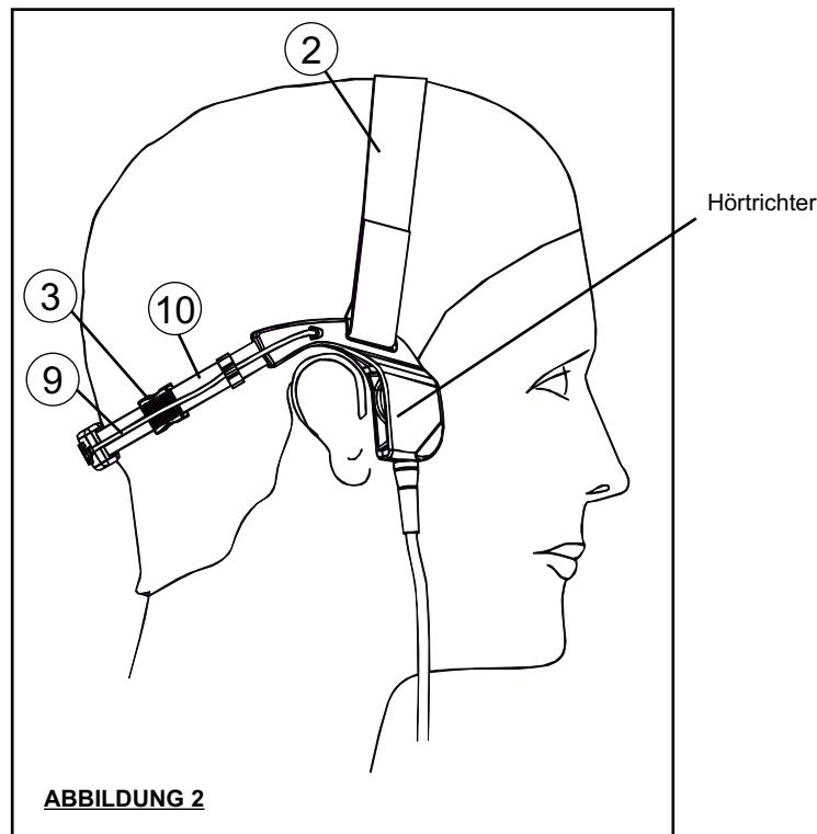
Setzen Sie das Kopfgeschirr gemäß Abbildung 2 auf. Der Bügel (10) liegt dabei im Nacken an und der Riemen (2) verläuft über dem Scheitelpunkt des Kopfes. Stellen Sie die Größe des Bügels (zwei ausziehbare Bügelhälften) mit Hilfe der Knöpfe (3) so ein, daß die beiden Hörtrichter auf den Schläfen anliegen.
