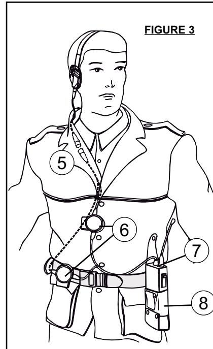
Connectez la fiche de raccordement (7) au poste émetteur-récepteur (8) (poste éteint).
