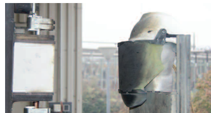
GS-ET-29 klasse 2-7 kA certificering geslaagd. Hoofd- en gezichtscombinatie beschermt de drager.
