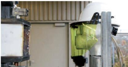
Set MSA di protezione contro l'arco elettrico prima del test a 7 kA
