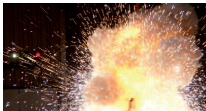
Elektrischer Lichtbogen 7 kA
