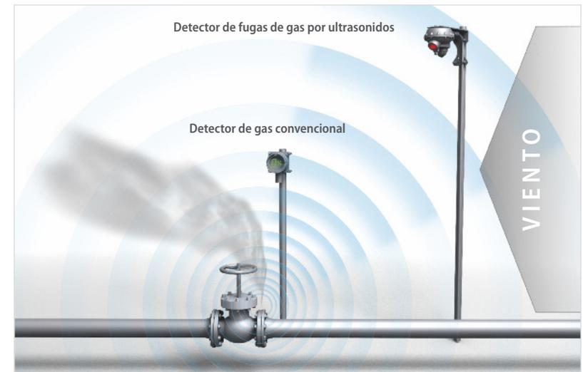
Los detectores de fugas de gas por ultrasonidos no requieren de contacto físico con el gas. No se ven afectados por el viento, la dilución del gas o la dirección de la pluma de gas.
