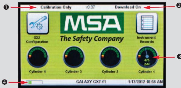
Der Bildschirm „Administrator“ umfasst die Konfigurationsoptionen für Prüfstation, Gerät und Prüfgasflaschen:
