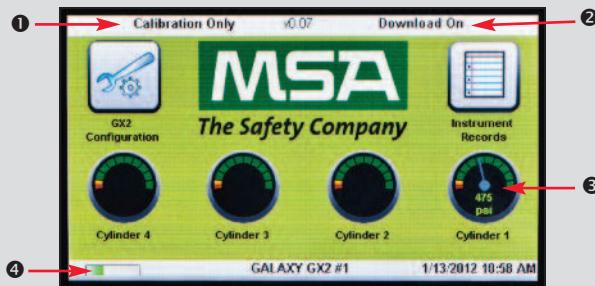
Экран «Администратор» позволяет конфигурировать опции для испытательного стенда, прибора и баллонов с калибровочным газом.
