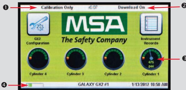
Obrazovka Správca ponúka možnosti konfigurácie pre testovací stojan, prístroj a fľaše so skúšobným plynom:
