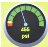
Muestran la presión de la botella de gas de prueba **solo del soporte electrónico de botella**. Seleccionando un manómetro se muestran los detalles de la botella de gas.
