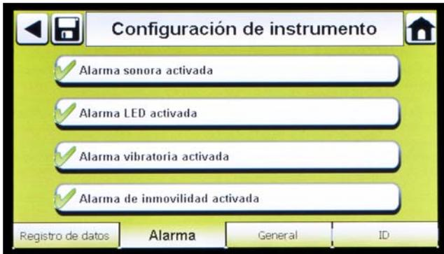
Fig. 20 Configuración del instrumento - Alarma
