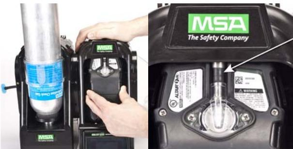
(2) Gire hacia arriba el instrumento en el soporte hasta el manguito de entrada de gas [véase la flecha]. El instrumento se bloqueará en su posición una vez se haya colocado correctamente.
