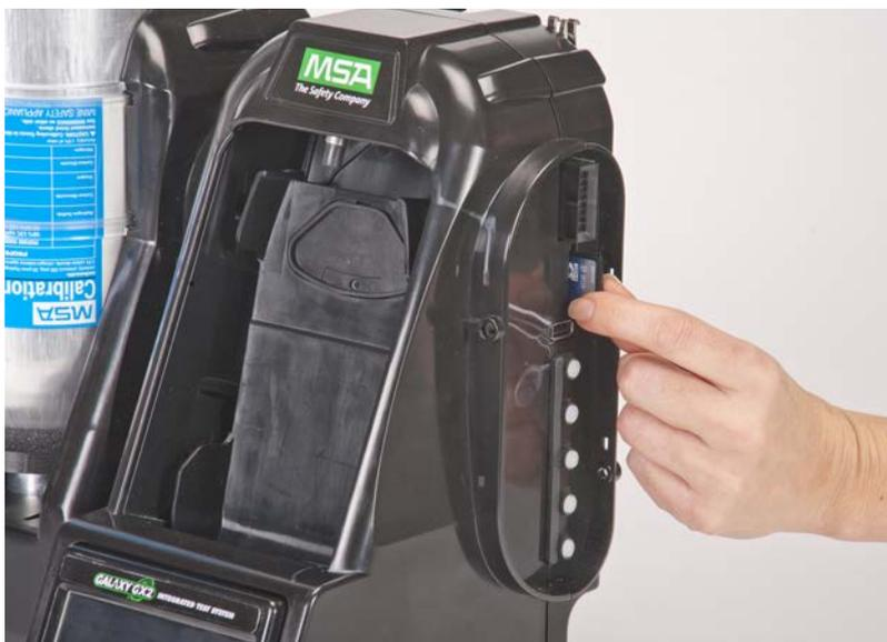
Fig. 13 Instalação de cartão de memória SD ou SDHC
