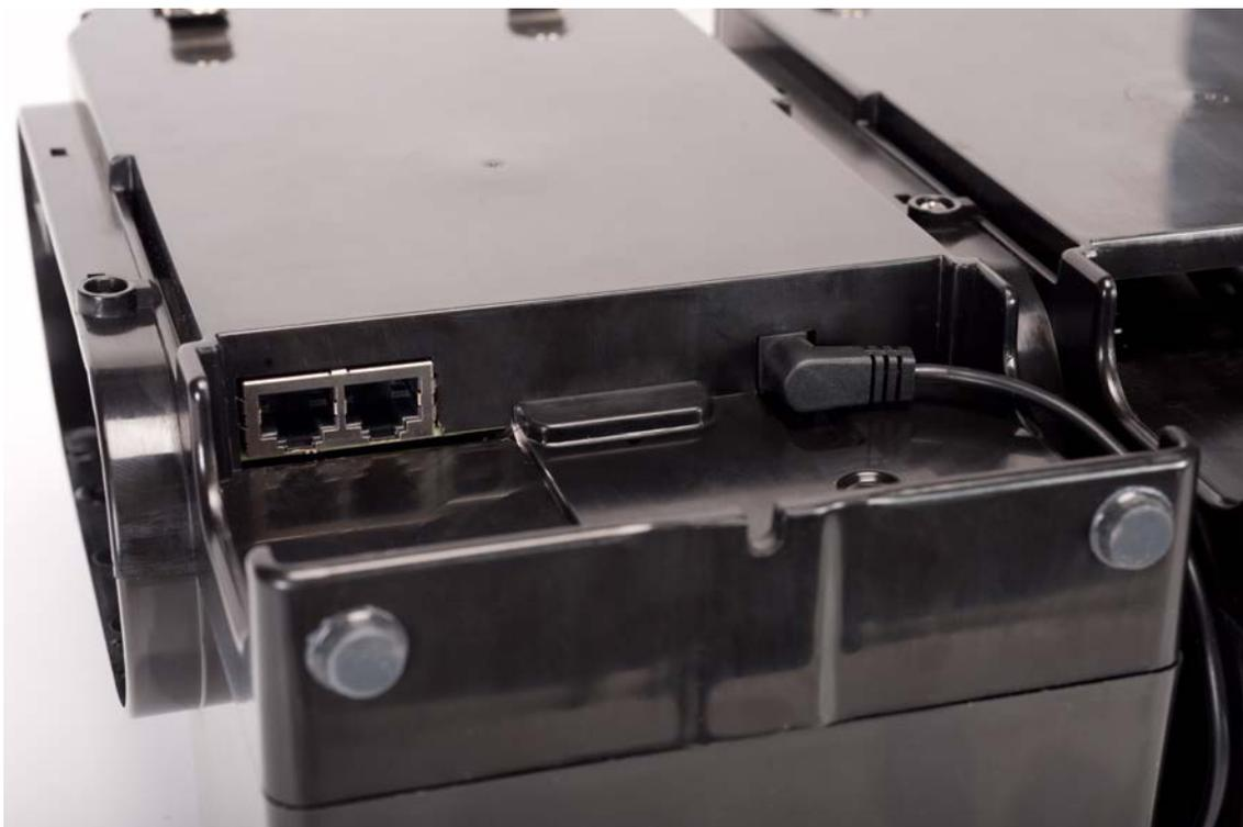
Fig. 6 Entradas Ethernet na Unidade de Teste
