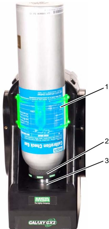
Fig. 7 Características Físicas do Suporte de Cilindro
