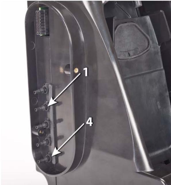
Fig. 17 Entradas de gás na Unidade de Teste
