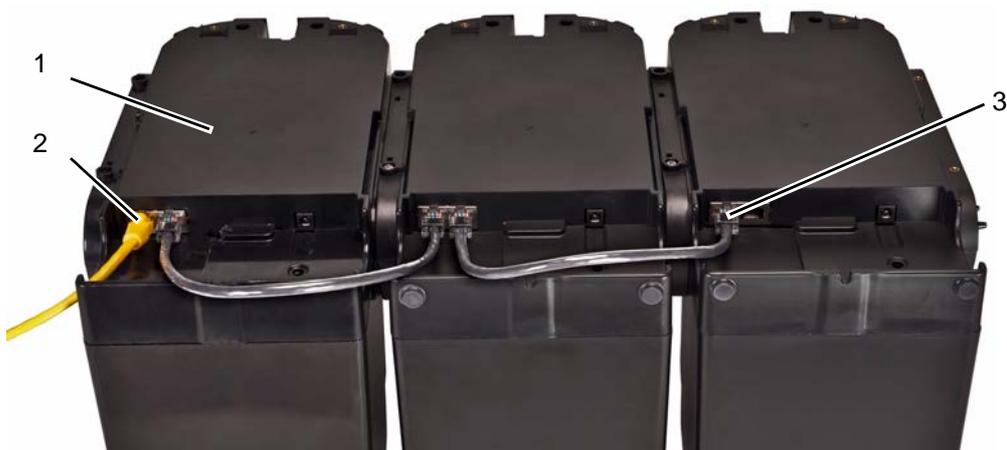
Fig. 11 Conexões Ethernet da Unidade de Teste
