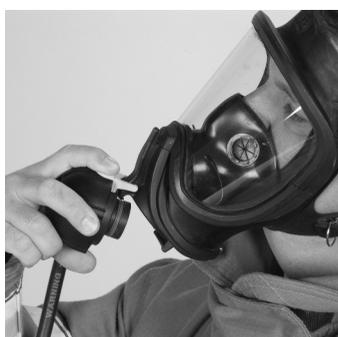
4. Cierre completamente la válvula del cilindro. Abra la derivación del regulador del FireHawk para liberar la presión del sistema. Cierre la derivación.
