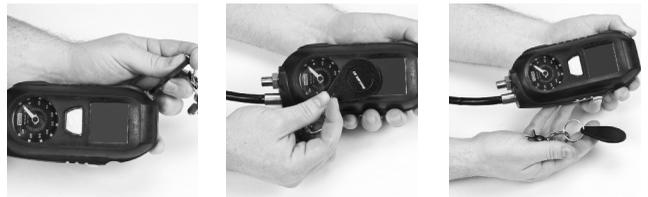
6. Si no se vuelve a presionar el botón MODE, se visualizará la palabra “TAG” (etiqueta) durante 10 segundos. Si se visualiza la palabra “TAG” (etiqueta) y se vuelve a presionar el botón MODE, el sistema PASS ingresará al modo de datos y aparecerá la palabra “DATA” (datos). Para regresar al modo de etiqueta, vuelva a presionar el botón MODE para tener acceso al modo de suspensión y repita los pasos anteriores.
