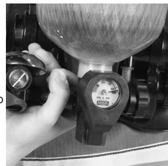
11. Enrosque la tuerca de acoplamiento de la alarma Audi-Larm en la rosca de la válvula del cilindro y ajústela a mano (sin herramientas).
