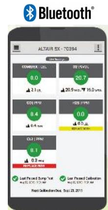
Adicionalmente posee compatibilidad con unidades de pruebas automatizadas para calibración y/o verificación GALAXY® GX2. MSA recomienda realizar la Verificación de los detectores de gas portátil siempre antes de su uso. Si el detector no pasa la Verificación deberá realizar la calibración antes de seguir utilizándolo.
