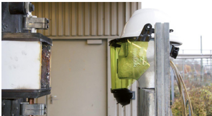
Conjunto MSA para arco eléctrico antes de la prueba "pruebas de arco-en-la-caja" 7 kA
