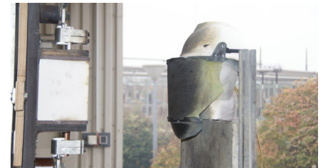
Certificación GS-ET-29 clase 2-7 kA aprobada. La combinación de cabeza y cara protege al usuario
