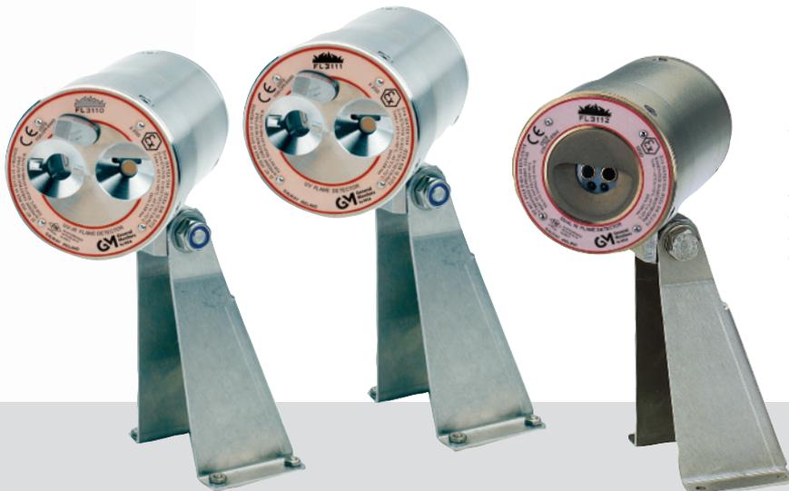
I rilevatori di fiamma **FL3110 (UV/IR)** (a sinistra), **FL3111 (UV)** (al centro) e **FL3112 (DFIR)** (a destra) sono progettati e approvati specificamente per il mercato europeo. Sono dotati di una custodia Exd in acciaio inox, funzionano fino alla temperatura di 90 °C e hanno un vano di cablaggio EEx-separato.
