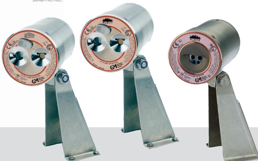
Los detectores de llamas **FL3110 (UV/IR)** (izquierda), **FL3111 (UV)** (centro) y **FL3112 (DFIR)** (derecha) están diseñados y homologados teniendo en cuenta el mercado europeo. Estos equipos cuentan con carcasa Exd de acero inoxidable, temperatura de funcionamiento de  $90^{\circ}\text{C}$  y compartimento de cableado EEx-e separado.
