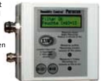
Die digitale Anzeige des Displays zeigt permanent den Feuchtigkeitsgehalt der Atemluft an.
