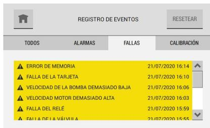
Las fallas pueden reconocerse y resetearse mediante la ventana emergente si se trata de una falla relacionada con el canal.
