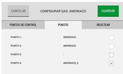
Si las configuraciones de alarma son distintas de las predeterminadas, seleccione el punto que requiere una configuración diferente, borre la marca de verificación y haga clic en “Guardar”.
