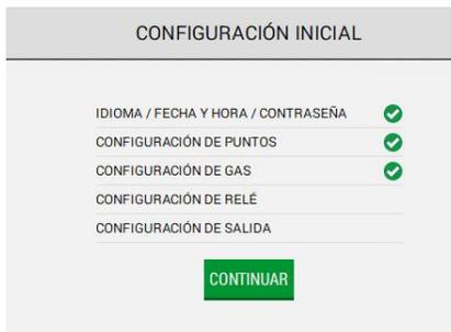
Listo (en la pantalla “Configuración inicial” aparece una marca de verificación junto al paso “Configuración de gas” para indicar que el paso se ha completado. Seleccione “Continuar” para pasar a la configuración de los relés).
