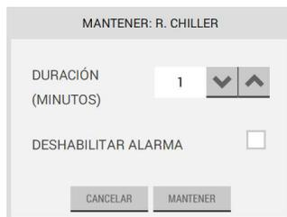
Para deshabilitar la alarma del punto durante el tiempo que dura la retención, seleccione la casilla de verificación “Deshabilitar alarma”.
