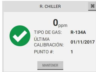
Para obtener información detallada sobre un punto en concreto, seleccione la ficha que corresponde a dicho punto en el tablero de control. Se abre una ventana con los detalles.
