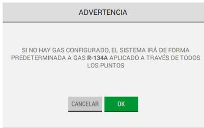
**NOTA:** Si se selecciona “Siguiente” sin configurar un gas, aparece un mensaje de advertencia que indica que se aplicarán los valores predeterminados a todos los puntos.
