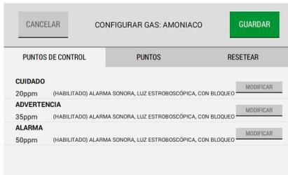
(4) Seleccione “Modificar” en los puntos de control que se quieren cambiar.
