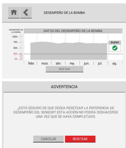
Para resetear la referencia del desempeño del sensor, seleccione “Resetear”.
