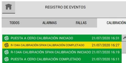
La pestaña “Calibración” muestra una lista con los intentos de calibración del instrumento.
