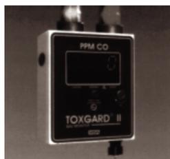
Para monitoramento contínuo dos níveis de CO em linha de ar comprimido.
