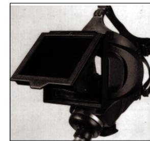
Fabricado em policarbonato, oferece proteção aos olhos para trabalhos com solda em áreas onde também é necessária a utilização de respirador. A parte frontal do Adaptador possui suporte móvel para fixação da lâmina filtrante e da cobertura, permitindo seu posicionamento para cima, quando necessário.
