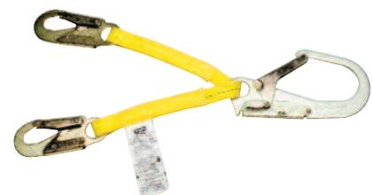
Los conectores de anclaje son compatibles para uso con elementos anticaída de MSA y con componentes de recuperación/entrada en espacios confinados. Su resistencia a la rotura es de 22,24 kN (como mínimo). Certificación según EN 795.
