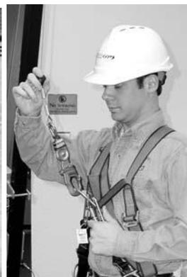
7. Conecte o anel em D do peito ao conector do trava quedas, isto é, guinche o dispositivo de controle descendente ou outra elevação, abaixando o dispositivo.
