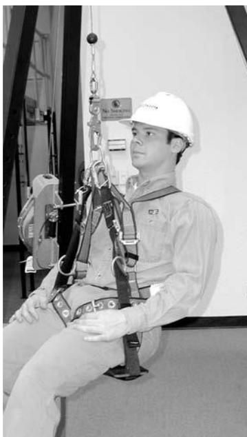
A função principal da cadeira suspensa MSA é servir como um dispositivo de posicionamento de trabalho. Ela fornece conforto ao aliviar a pressão na área subpélvica do usuário e seu equipamento de segurança.
