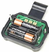
Fig. 13 Cambio de la batería
