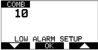
Fig. 9 Configuración de las alarmas del sensor
