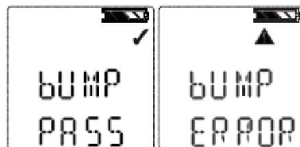
O símbolo ✓ é exibido no Modo de Medição durante 24 horas após um teste de resposta bem-sucedido.
