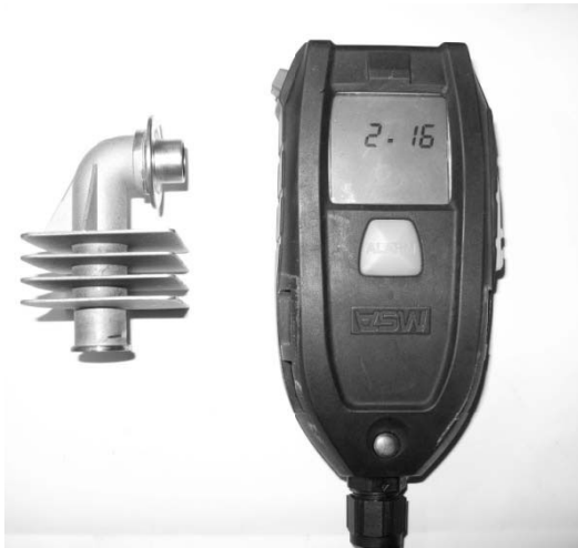
Rys. 2 Nowy typ chłodnicy wstępnej, wyświetlenie wersji oprogramowania IC-Air
