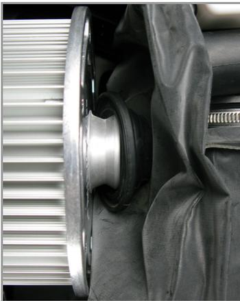
Fig. 6 Conexión del conector superior del cartucho
