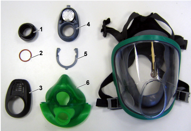
Fig. 5 Demonteren van de Advantage AirElite
