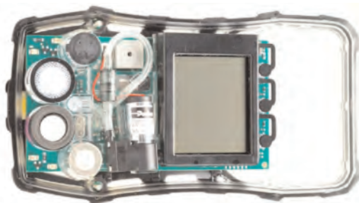
Figure 4-3. Remplacement de capteurs
