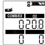
Tras finalizar la prueba funcional, el equipo muestra brevemente "BUMP PASS" [prueba funcional finalizada con éxito] o "BUMP ERROR" [fallo en la prueba funcional] junto con la etiqueta del sensor que haya fallado, antes de regresar al modo de medición. Si el equipo no concluye con éxito la prueba funcional, realizar una calibración tal y como se describe en el capítulo 3.9.
