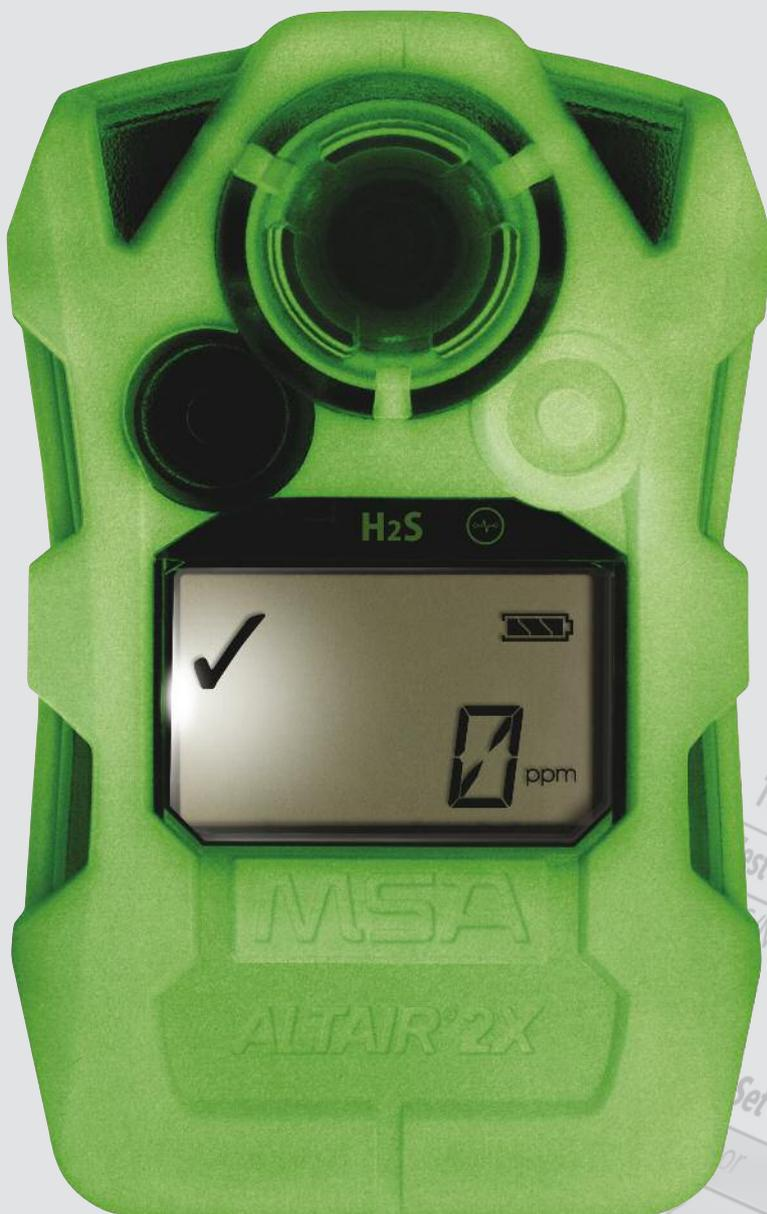
**ЗАПИСИ ПРИБОРА СОХРАНЯЮТСЯ** и могут быть легко загружены во время периодической калибровки с помощью испытательного стенда Galaxy GX2. Программное обеспечение MSA Link Pro обеспечивает все возможности для работы в сети.
