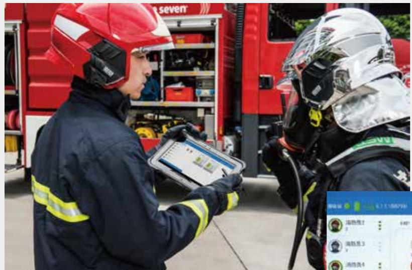
指挥员可根据实际需要对消防员进行分组，并实时查看所派遣的消防员状态信息，包括气瓶气压、气瓶气量、气瓶压力值及剩余时间、数字通讯模块与无线连接情况，以及数字通讯模块与空呼连接情况。
