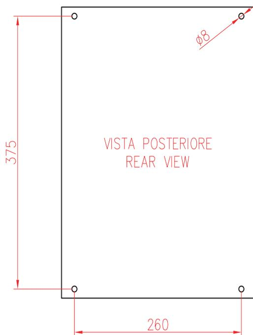
FORI DI FISSAGGIO Ø8
