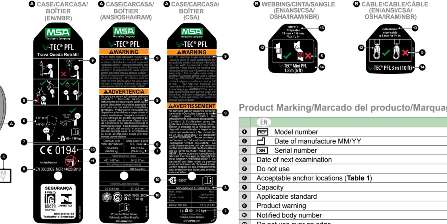
**Figure 1 - Load indicator/ Figura 1 - Indicador de carga/ Figure 1 - Indicateur de charge****Product Marking/Marcado del producto/Marquage du produit**
