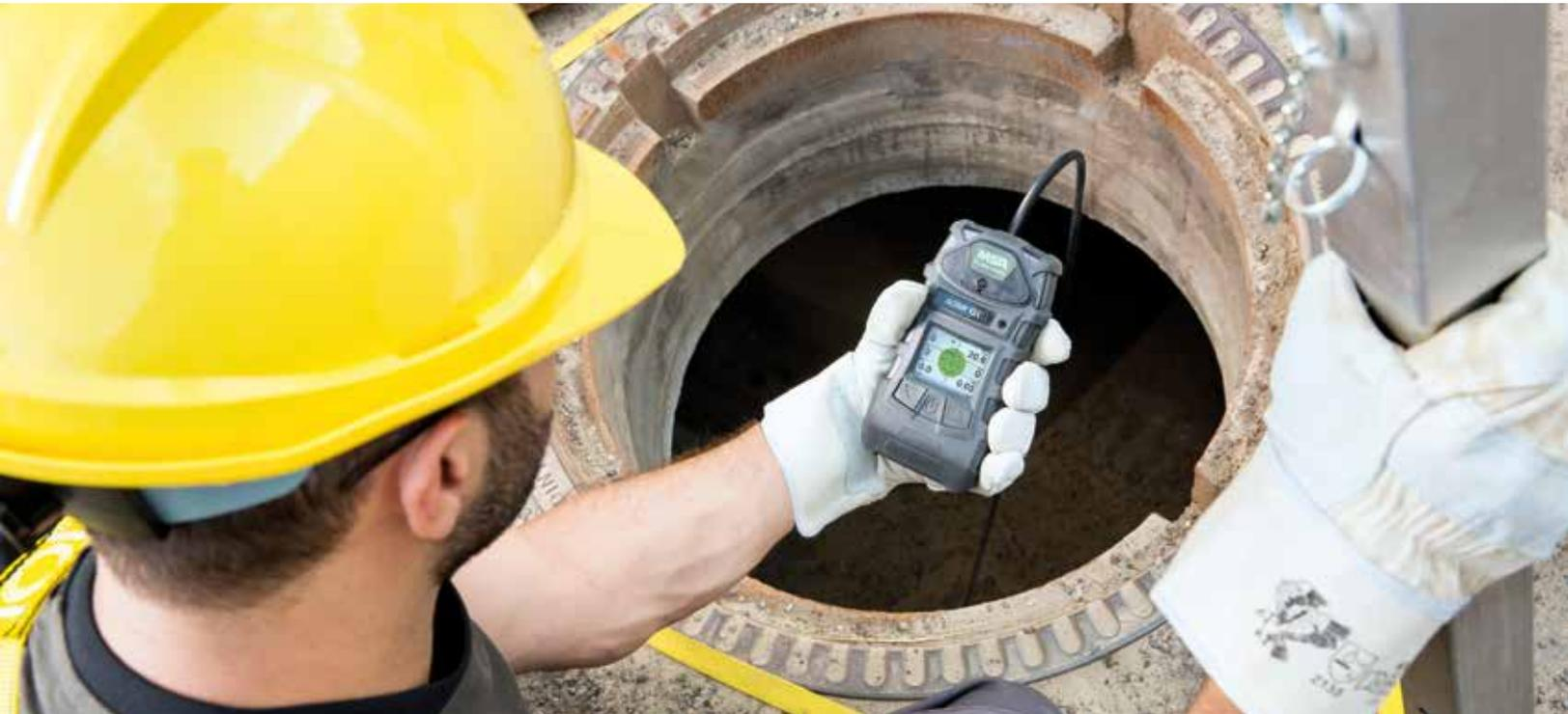
Los espacios confinados son usados para almacenar productos del petróleo, productos químicos, y otras sustancias que a menudo pueden absorber o retener material. Cuando el espacio se vacía para mantenimiento, limpieza u otros propósitos, este material absorbido puede desprenderse de las paredes, cambiando la composición del ambiente de espacio confinado.
