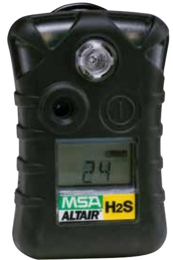
Considerando que , la mayoría de los monitores de un solo gas operan en el modo de difusión, algunos instrumentos multigas portátiles utilizan bombas para extraer muestras de las inmediaciones o desde fuera del espacio confinado de trabajo cuando se utilizan líneas de muestreo. El usuario observa la lectura del sensor en la pantalla digital del instrumento. Independientemente del número de sensores utilizados, todos sensores monitorean y muestran sus lecturas en pantalla continuamente.
