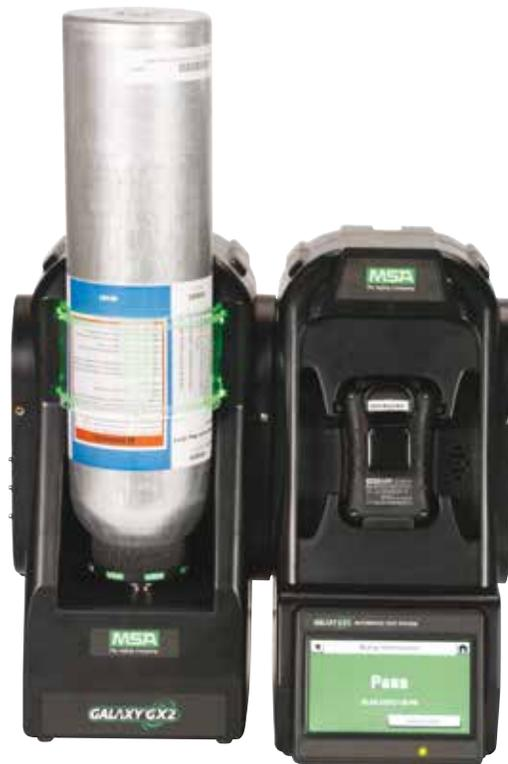
El nuevo sistema de pruebas automatizado GALAXY GX2 permite verificar y calibrar de manera fácil e inteligente todos los detectores MSA.
