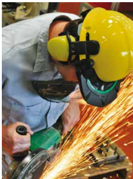
Ensamble visor Defender® + utilizado en aplicaciones que demandan protección visual y a la cara contra partículas abrasivas, objetos y chispas de químicos.
