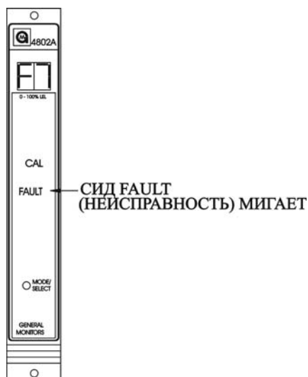
Рис. 46. Индикация кода ошибки F7 в процессе калибровки
