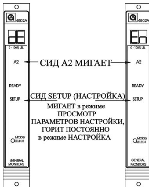
Рис. 50. Выбор исходного состояния реле сигнализации А2
