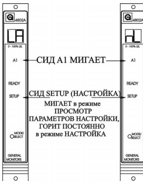
Рис. 54. Выбор фиксирующегося/нефиксирующегося режима сигнала А1
