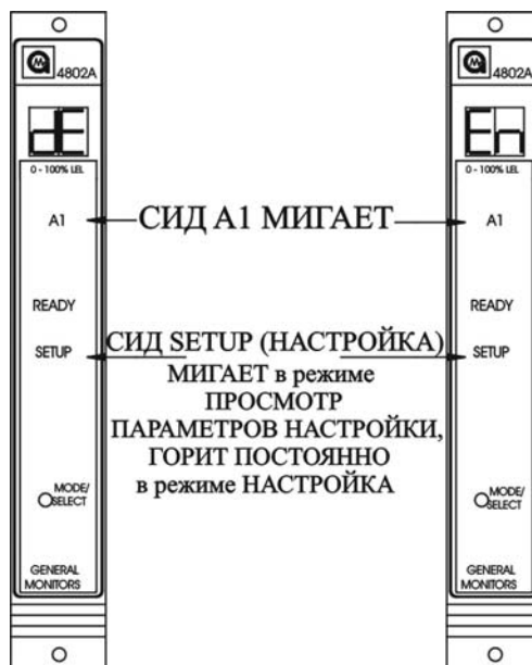
Рис. 53. Выбор исходного состояния реле сигнализации А1
