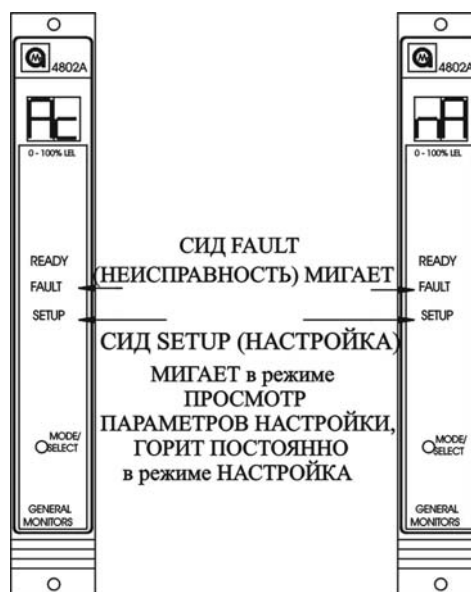
Рис. 57. Выбор режима сигнализации неисправности в состоянии блокировки
