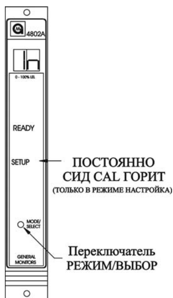
Рис. 49. Переключение в режим блокировки
