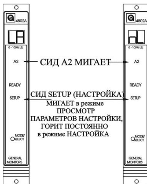
Рис. 51. Выбор фиксирующегося/нефиксирующегося режима сигнала А2
