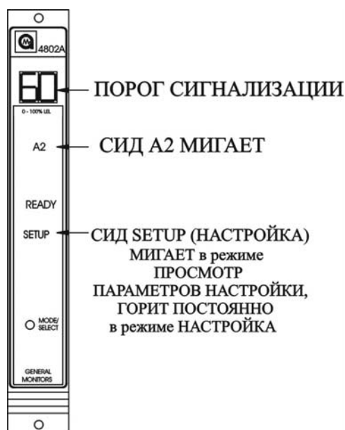
Рис. 52. Выбор порога сигнализации А2
