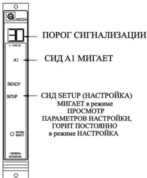
Рис. 55. Выбор порога сигнализации A1
