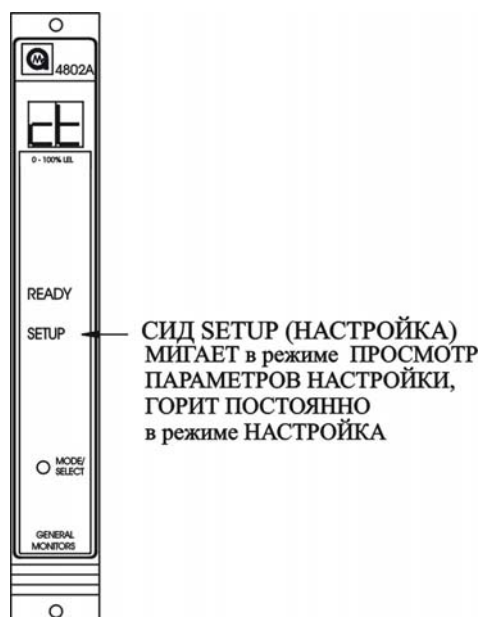
Рис. 58. Установка параметров функции «Тест платы»
