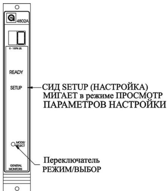
Рис. 47. Переключение в режим настройки и режим просмотра параметров настройки
