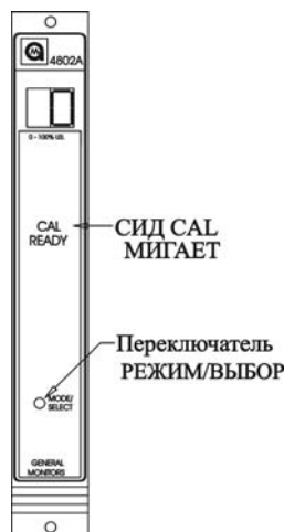
Рис. 40. Переключение в режим поверки
