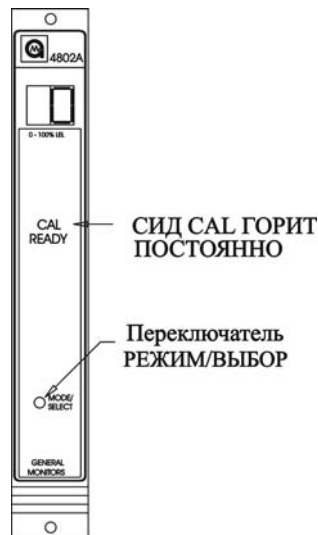
Рис. 42. Переключение в режим калибровки
