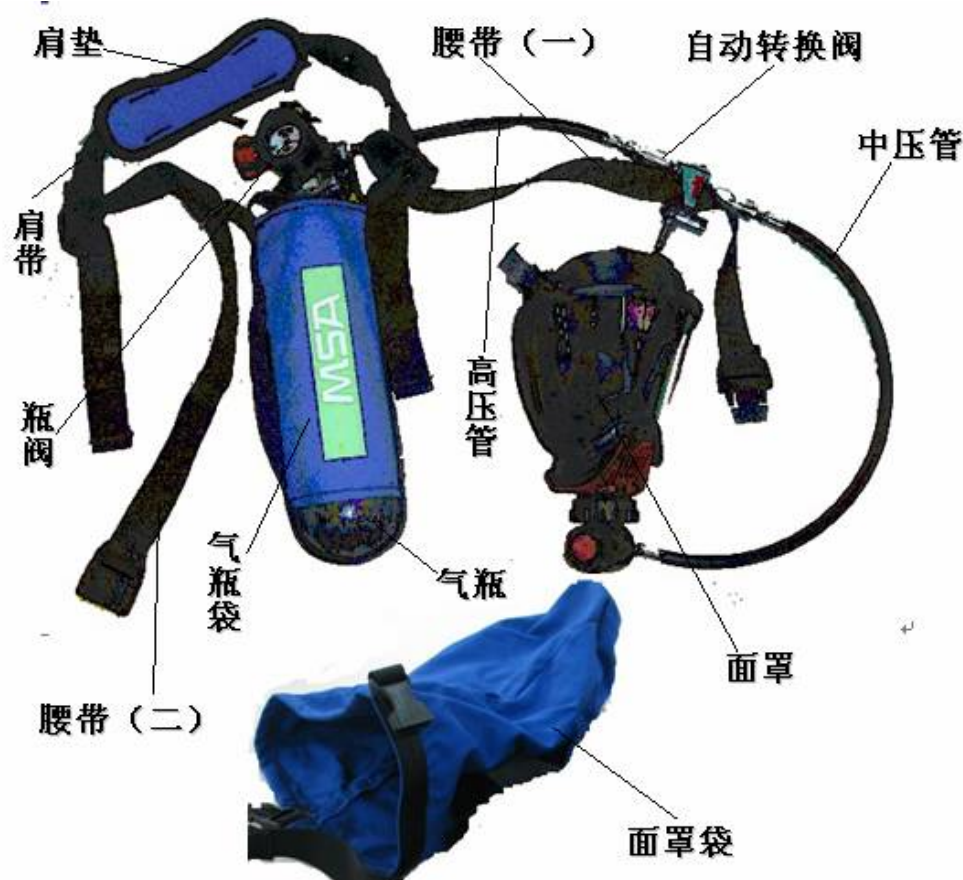
图 1 逃生呼吸器的组成（图示为 2 升气瓶规格）
