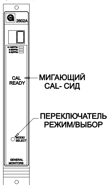
Рисунок 15 Переключение в режим поверки
