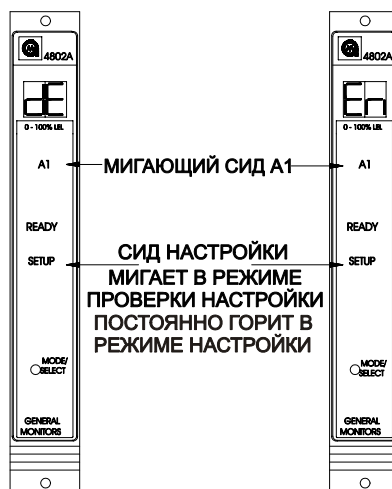
Рисунок 28 Выбор исходного состояния реле сигнализации А1
