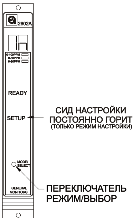
Рисунок 24 Переключение в режим блокировки
