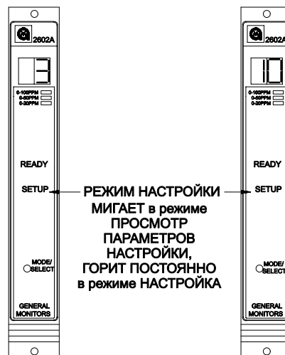
Рисунок 32 Установка параметров функции «Тест платы»
