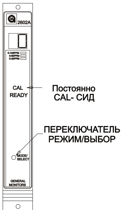
Рисунок 17 Переключение в режим калибровки
