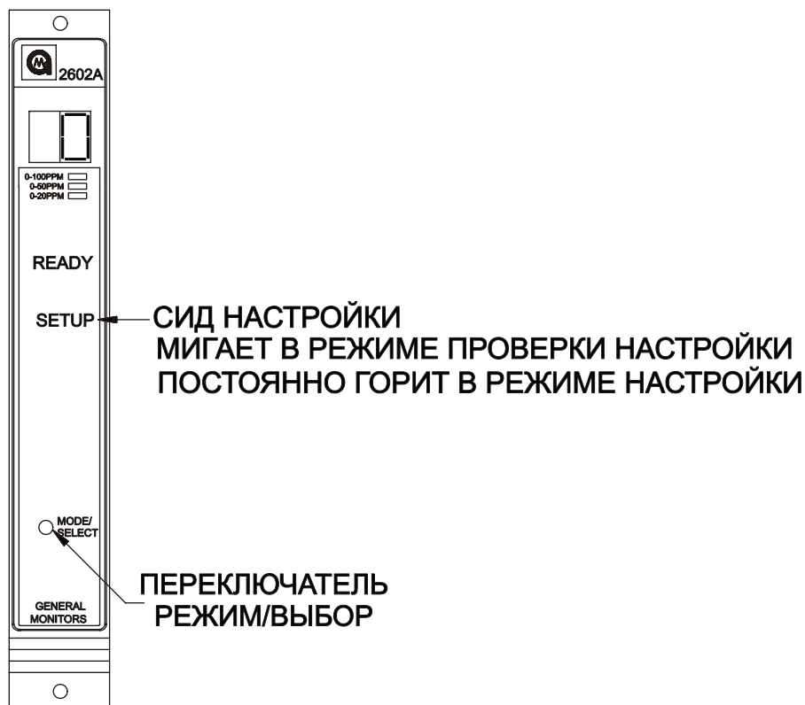
Рисунок 22 Переключение в режим настройки и режим просмотра параметров настройки
