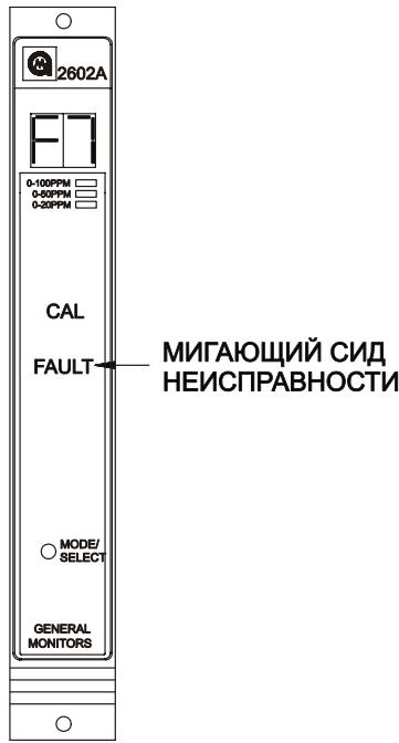
Рисунок 21 Индикация кода ошибки F7 в процессе калибровки
