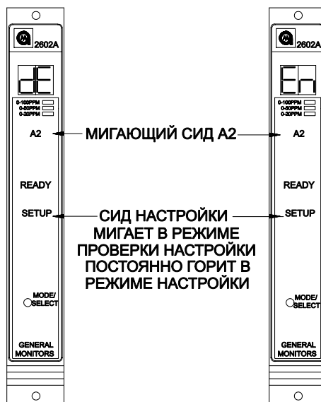
Рисунок 25 Выбор исходного состояния реле сигнализации А2
