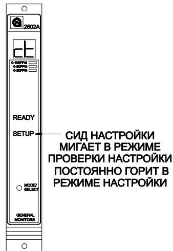
Рисунок 32 Установка параметров функции «Тест платы»
