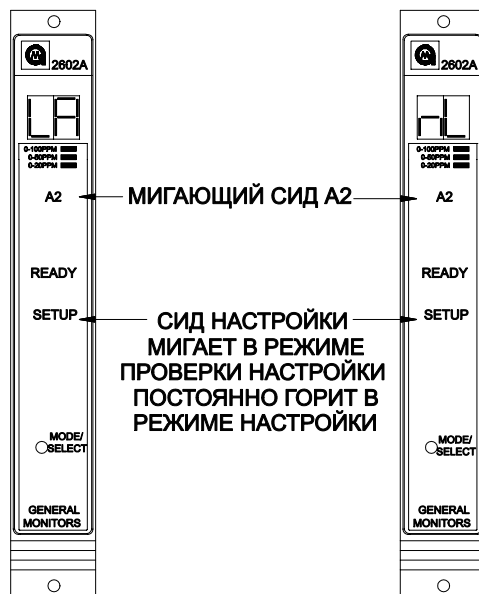
Рисунок 26 Выбор фиксирующегося/нефиксирующегося режима сигнала А2
