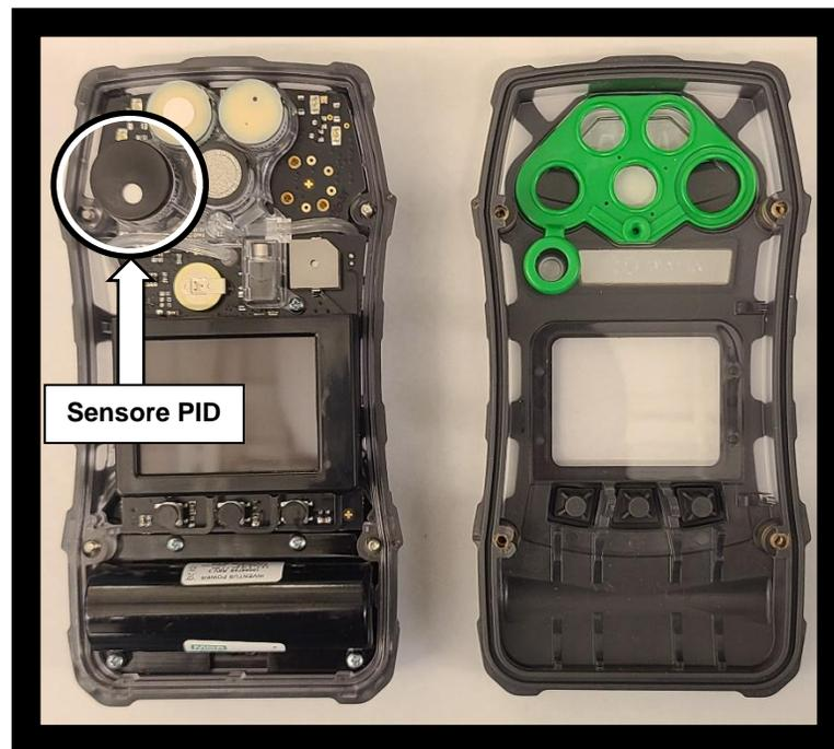
**Figura 3 - Accesso al sensore PID**
