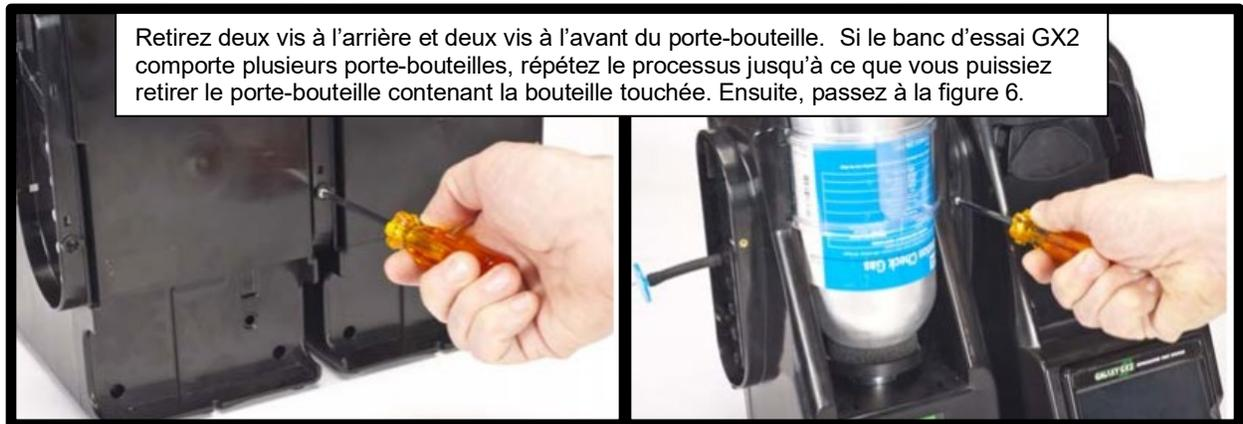
**Figure 5 – Retrait d'un porte-bouteille d'un banc d'essai GX2**
