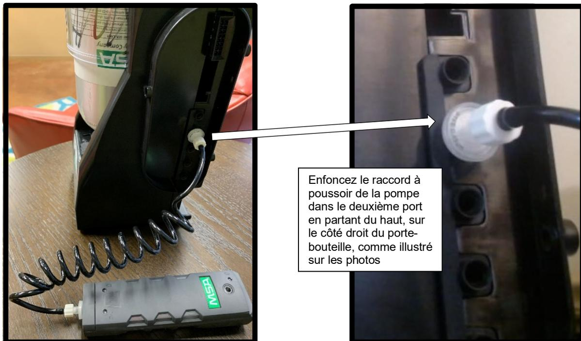
**Figure 6 – Raccord de la sonde de pompe au porte-bouteille**
