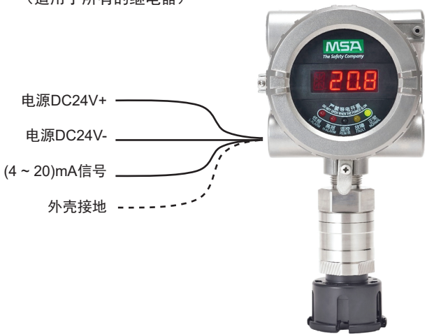
图8 DF-8500 三线制连接
