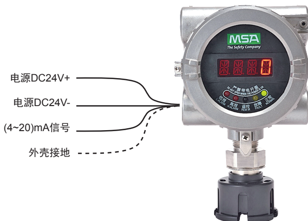
图8 GTYQ-DF-8500 C 三线制连接
