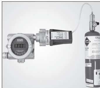
图7 MSA HART标定帽（使用计算机进行标定时使用）
