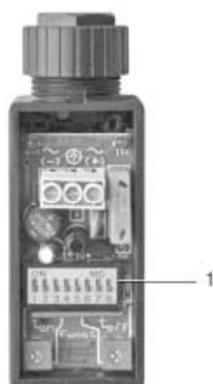
图 41 冷凝排水计时器
