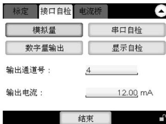
图 30 模拟输出测试
