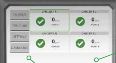
仪表操作与状态显示盘, 方便进入设置、事件日 志、诊断和校准模式 7" (178 mm) 彩色触摸屏
